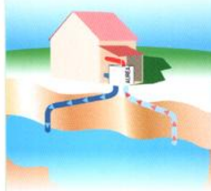
Captage sur eau de nappe
